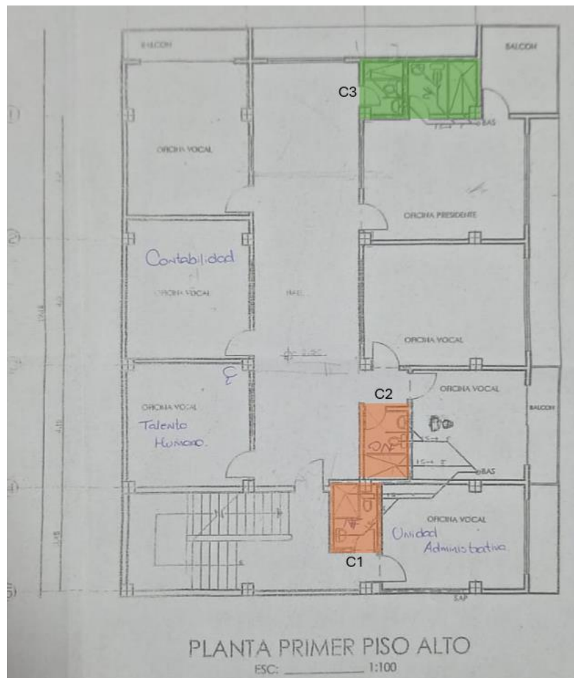
Fig. 5 Implantación sanitaria primera planta
